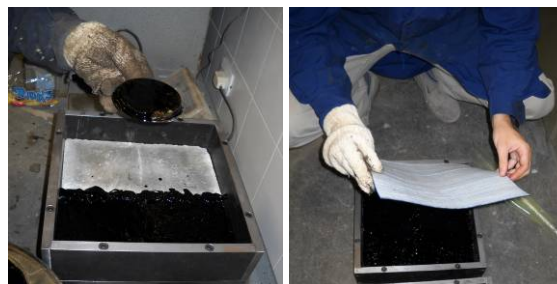
Figura 8. Riego y colocación del geosintético.
