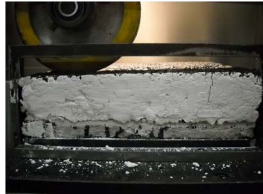
Figura 17. Evolución de fisura para el material FM PP
