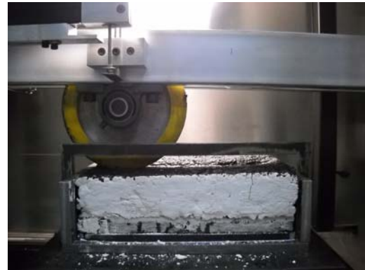
Figura 11. Ensayo con cara descubierta para el material FM PP.
