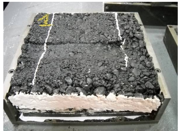
Figura 15. Ahuellamiento sobre probeta utilizando el material HSK PET.
