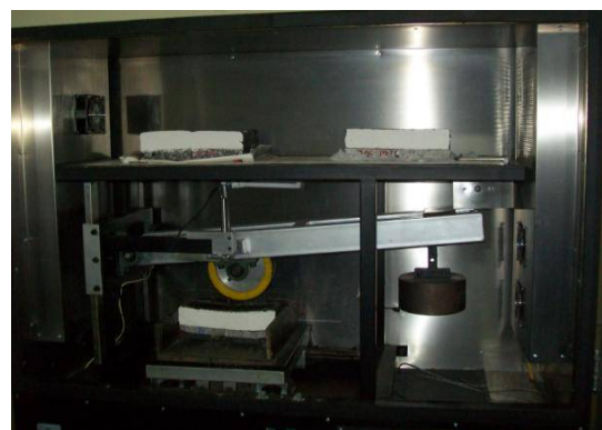
Figura 5. Equipo de rueda cargada, Wheel Tracking Test.
