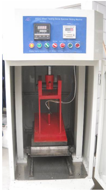
Figura 9. Compactación de la mezcla asfáltica mediante el equipo Roller Compact.
