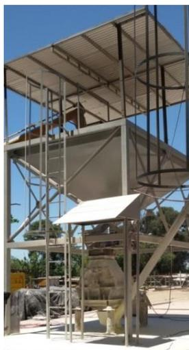
**Figura 1.** Sistema de alimentación y molienda.
