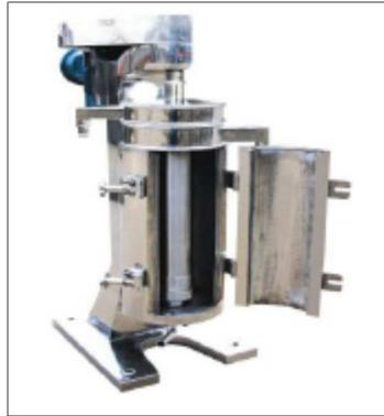
Figura 7.10: Centrifuga Tubular.
