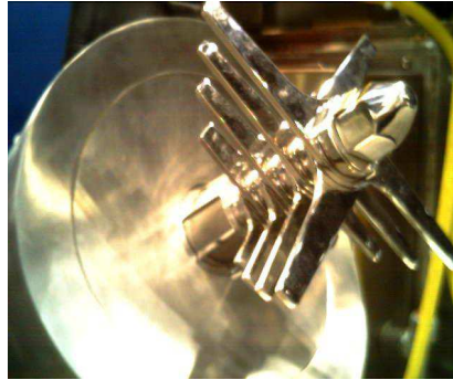
Figura 7.12. "Choppers" (molinos desglomeradores). Fuente. http://www.mezcladores.com/secadores
