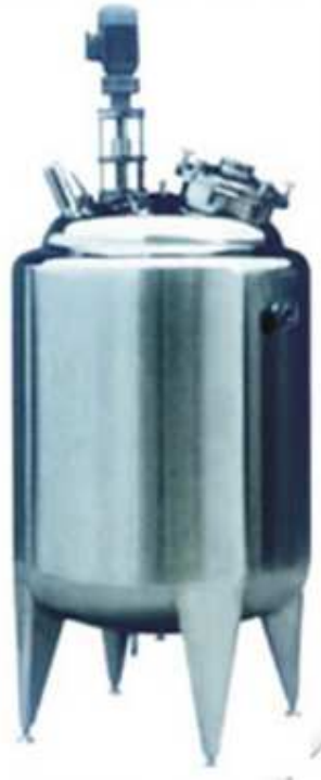
Figura 7.7. Tanque T-04, con agitación y camisa.
