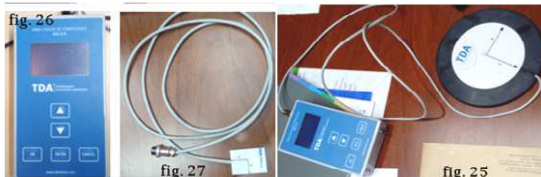
Fig.26 – Instrumento para Medir Vibraciones con los sensores de Cuerpo Entero (fig. 25) y Sensor de Mano-Brazo ( fig. 27)
