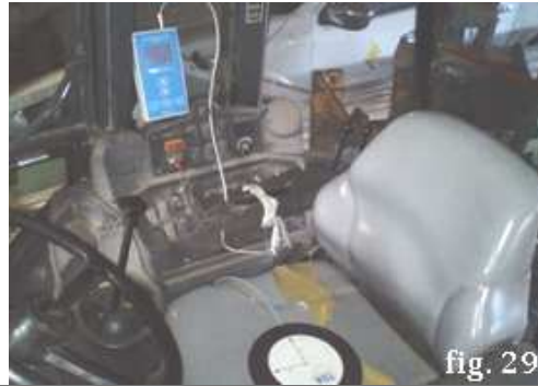
Fig.29 – Posición del Sensor de Vibraciones Cuerpo Entero en la respectiva medición Realizada
