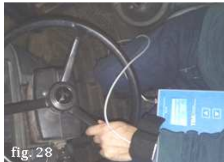
Fig.28 – Posición del Sensor de Vibraciones Mano-Brazo en la respectiva medición Realizada 310J/K
