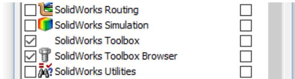
Haga click en aceptar, y aparecerá el menú Toolbox en la parte superior de la pantalla, esto le permitirá insertar un elemento normalizado en un archivo de ensamblaje.
