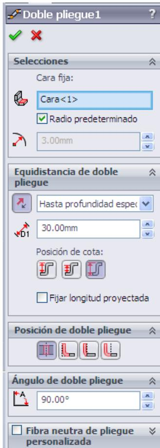
Pulse **Doble Pliegue**
