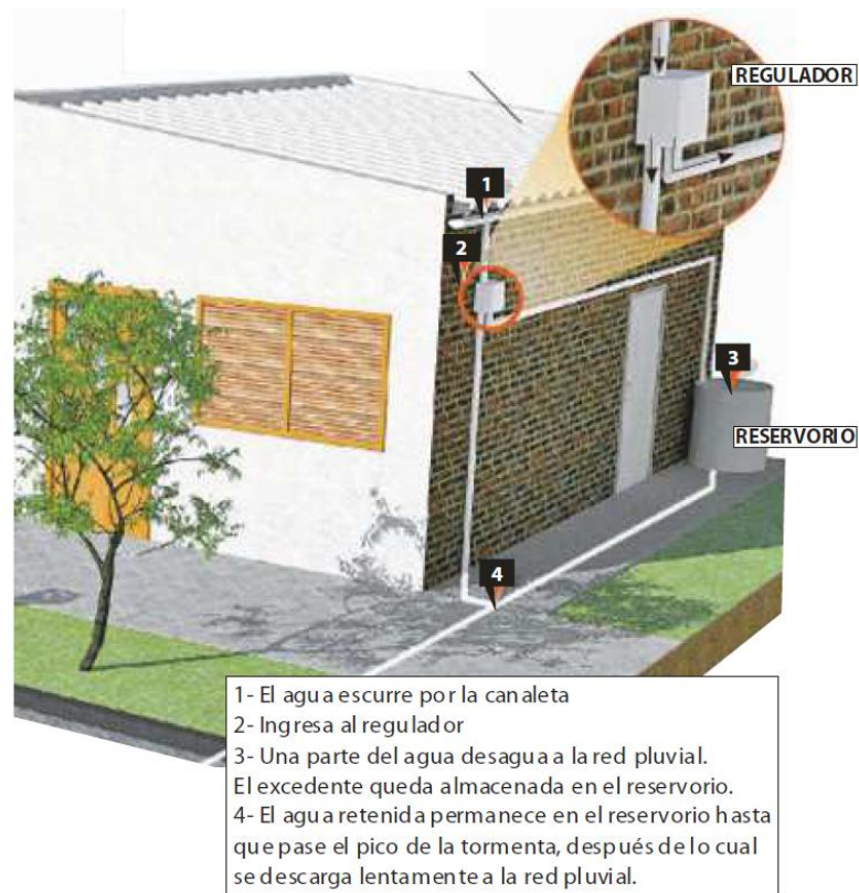
a.- Etapas esquemáticas de funcionamiento del dispositivo domiciliario.
