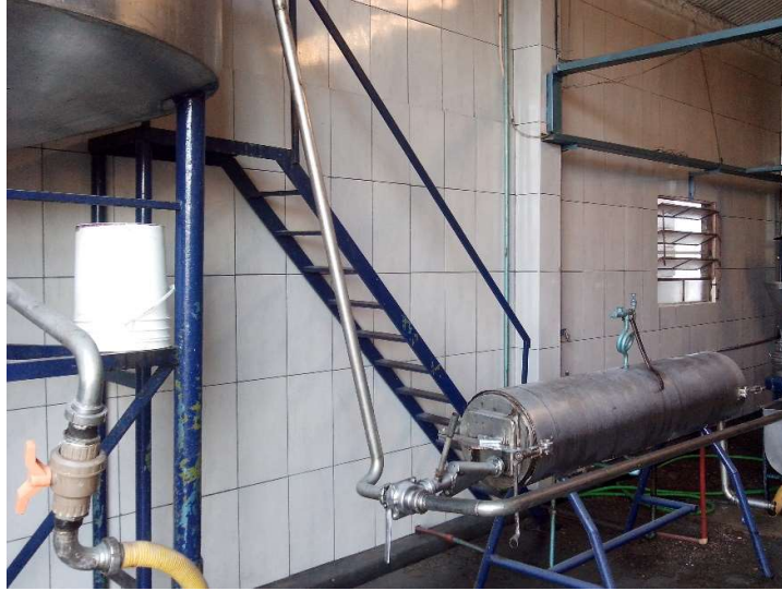
Imagen N°17: Foto del pasteurizador de la fábrica de cremogenado de la Citrícola Santa Carmen.
