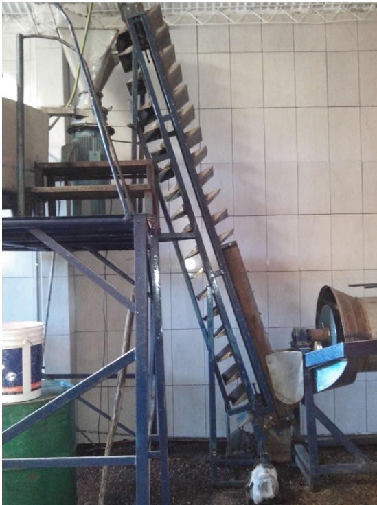
Imagen N°17 y 18: Foto de elevador por cangilones (izquierda) y foto de los molinos coloidales (derecha) de la fábrica de cremogenado de la Citrícola Santa Carmen.
