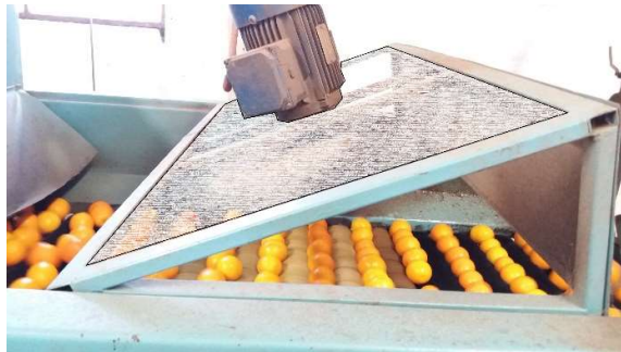
Imagen N°35: Ilustración (propuesta) de protección (malla metálica) en ventilador
