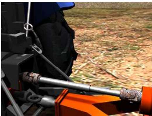
Imagen N°29: Ilustración de una toma de fuerza sin protección
