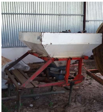
Imagen N°11: Foto de la abonadora de línea perteneciente a la Citrícola Santa Carmen.
