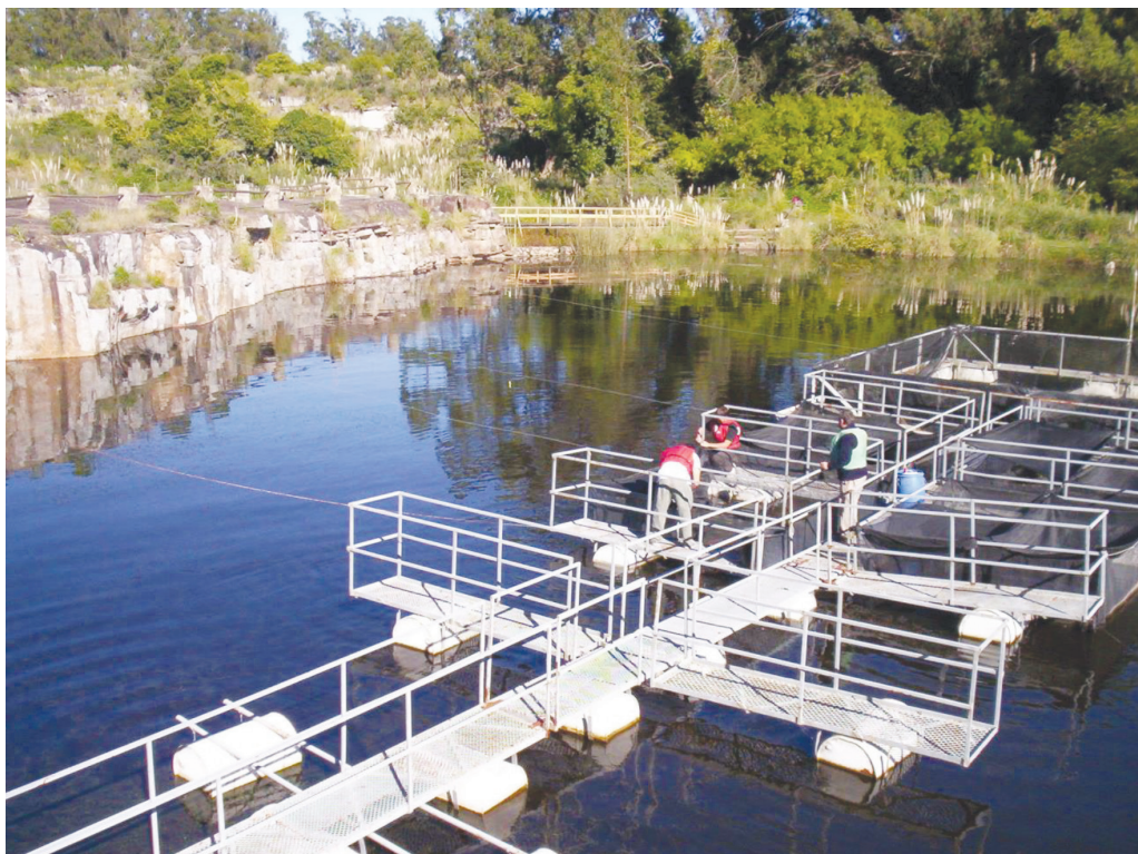
Fig. 2. Contenedores flotantes de engorda de peces en la Cantera Paso de Piedra, Argentina.
