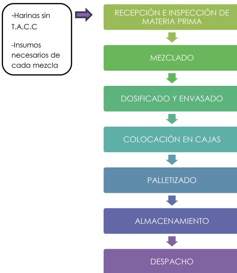
Figura 7.1 Diagrama de Proceso de Pre-mezclas
