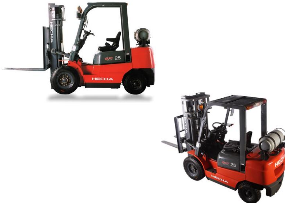
Figura 31: Autoelevador con torre doble
