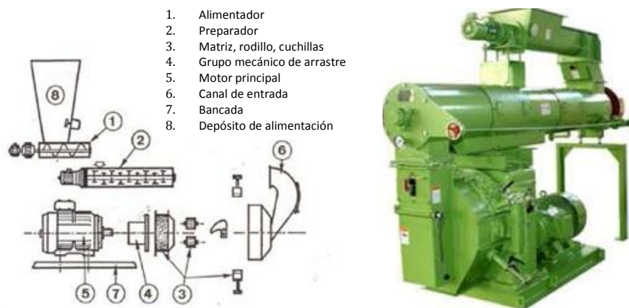
Figura 15: Esquema básico de una peletizadora de eje horizontal
