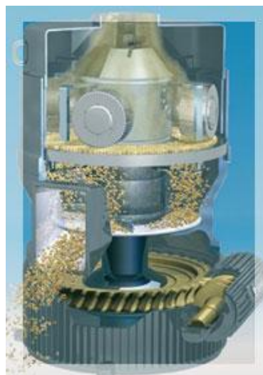
Figura 16: Esquema básico de una peletizadora de eje vertical
