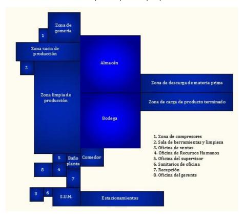
En el siguiente diagrama dimensional de bloques se puede observar la disposición final en función de la redistribución de los espacios:
