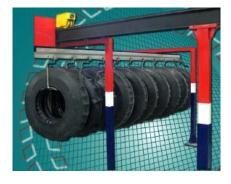
De esta manera el neumático recorre la línea de producción sin tocar el piso, evitando su contaminación.
