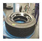
logra así que la pared externa e interna y la banda de rodamiento a vulcanizar queden al vacío y aisladas de la presión interna del autoclave.
