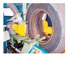
imperfecciones tales como: sopladuras, rupturas de las telas que forman el neumático, ruptura de talones o del mismo cuerpo del neumático. Algunas de estas imperfecciones pueden ser salvadas mediante la utilización de parches y de esa forma poder realizar el recapado sin ningún inconveniente. Una vez finalizada la inspección se debe etiquetar e indicar el diseño y trabajo adicionales a los neumáticos que han pasado la inspección inicial.
