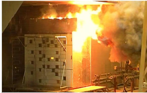
Fig.3.9- Imagen de un ensayo de Arco Interno en Celda (13.2 kV)
