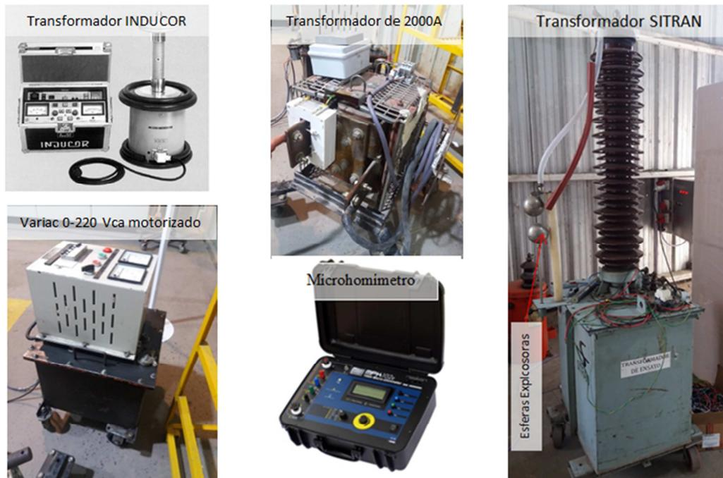
Fig.8.1-Equipos para los ensayos de Rutina
