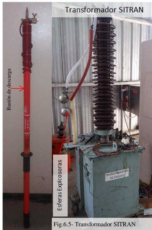
Fig.6.5- Transformador SITRAN
