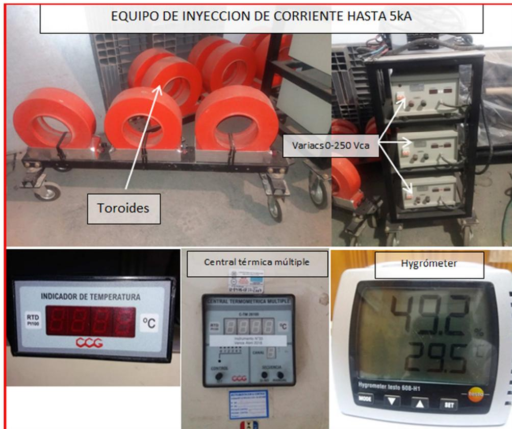
Fig.8.2-Equipos e Instrumentos para el Ensayo de Calentamiento
