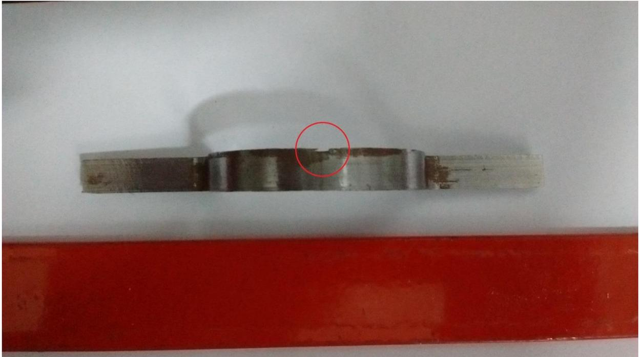
La omega de la foto superior se torció durante el mecanizado y la herramienta de corte fresó por demás y produjo la mueca que se ve en el círculo rojo
