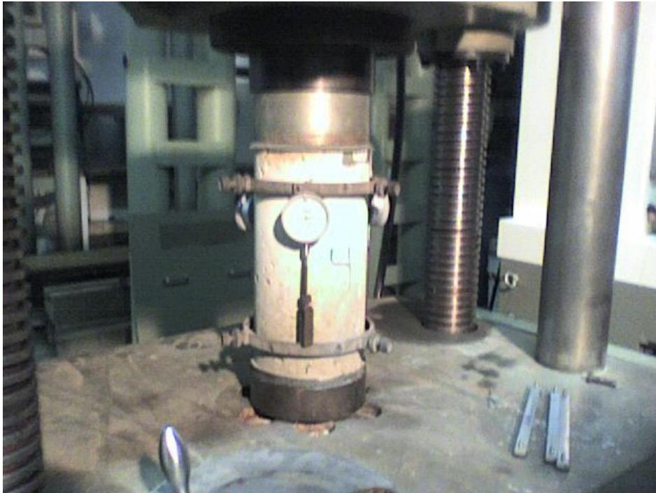
Figura 1: Probeta con comparadores
