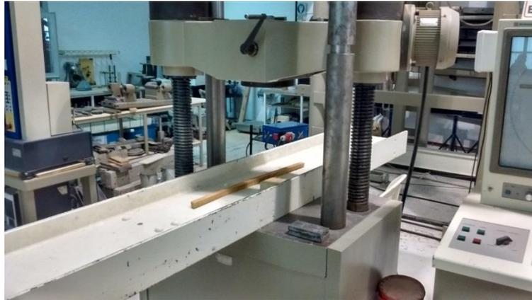
La simulación en solidworks determinó que el perfil se deforma 0,85 mm al aplicar 2500Kg sobre cada uno de los apoyos.
