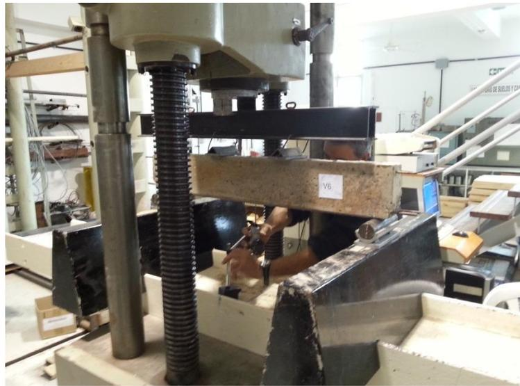
Figura 4: Apoyos ensayo de vigas
