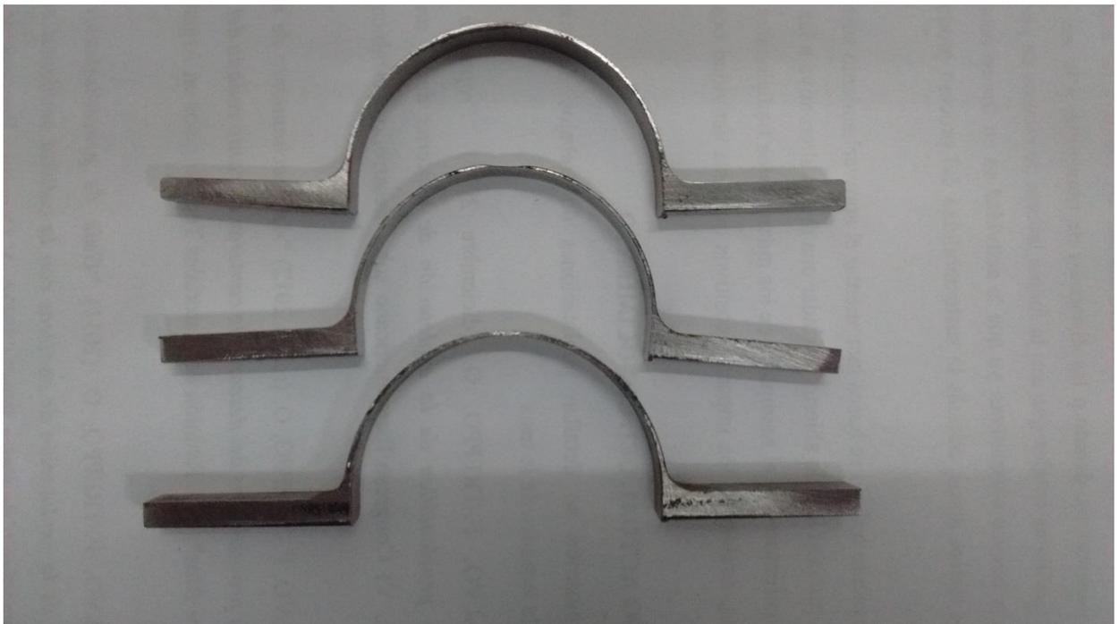
Las tres primeras omegas mecanizadas. Solo la de más abajo no presenta signos de haberse deformado durante el mecanizado
