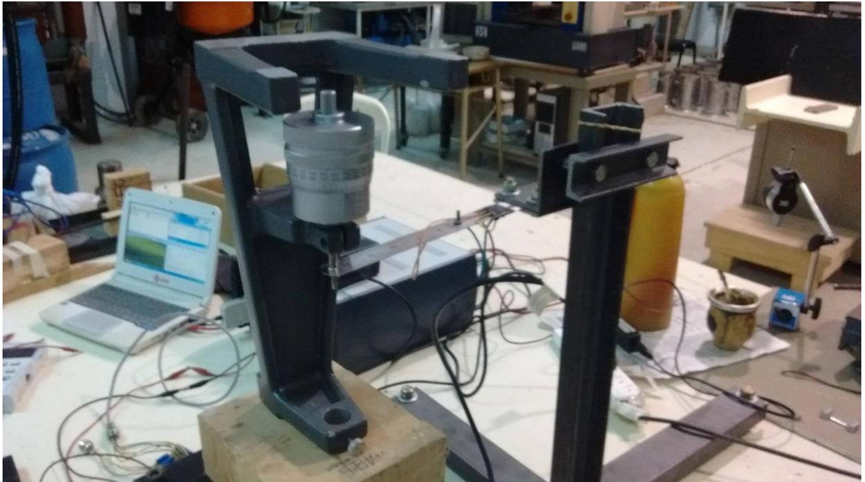
En la figura superior se puede apreciar el sensor y el tornillo micrométrico.
