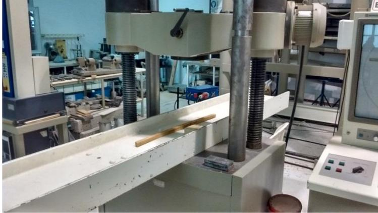
Figura 3: Viga IPN400 sobre máquina de ensayos
