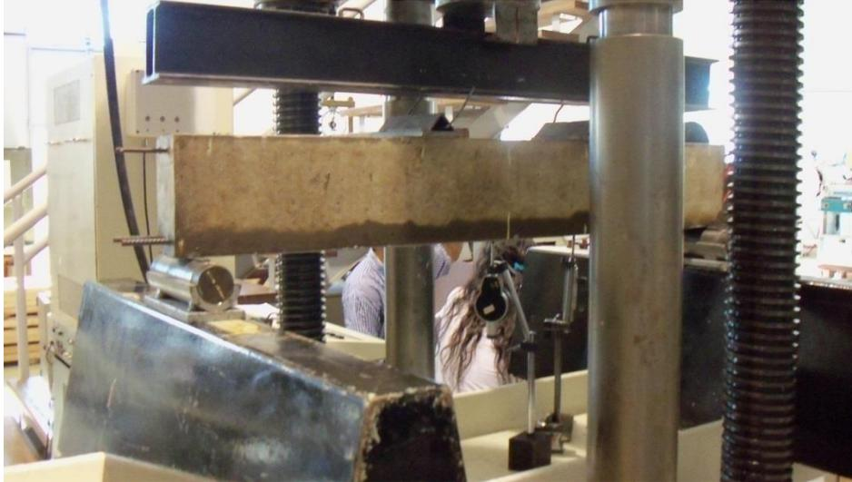
Figura 2: Viga y comparador
