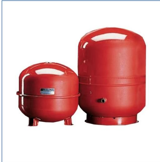
Se necesitan 3 tanques de expansión (Cod. Te01/02/03) para la instalación solar, uno por cada circuito de colectores. Los mismos están contruidos en acero estampado en frío y la membrana interior es de goma sintética. Otras características técnicas se describen a continuación:
