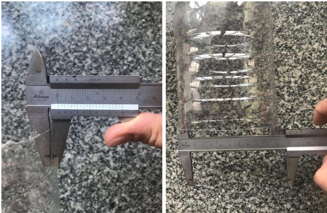
Figura 12: Espesor (izq.) y diámetro interior (derecha) de una botella PET comercial.
