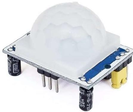
*Figura 71: Sensor infrarrojo de movimiento HC Sr501*
