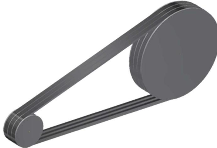
Figura 24: Sistema de reducción por poleas modelado en Autodesk Inventor
