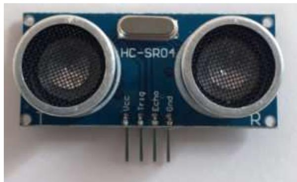
*Figura 73: Sensor de nivel ultrasónico HC-SR04*
