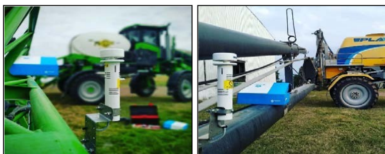
Figura 3: Sensores colocados en botalones de pulverizadoras
