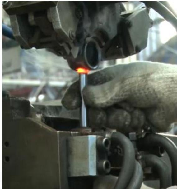
*Ilustración 10 Proceso de soldadura del conjunto vástago-anclaje.*
