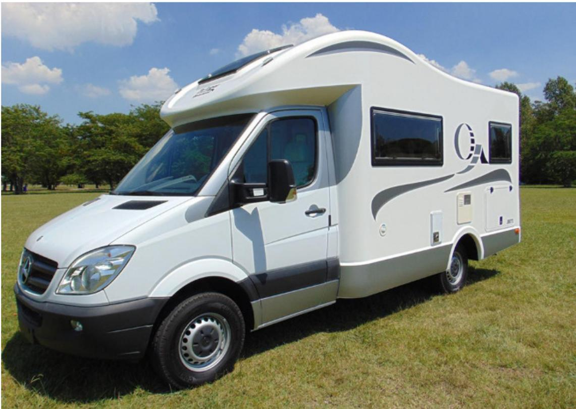
*Ilustración 6 Motorhome sobre chasis de Mercedes Benz Sprinter 415 CDI*
