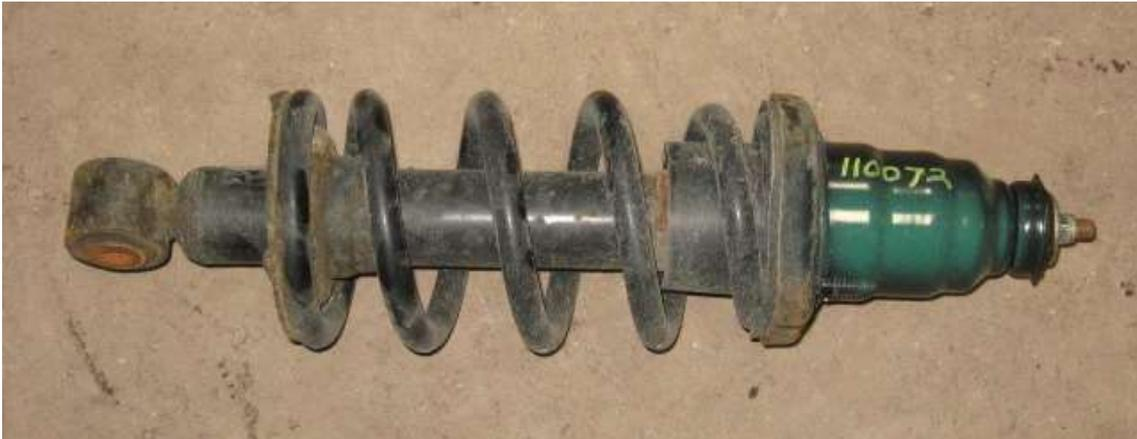
*Ilustración 2 Amortiguador corroído*
