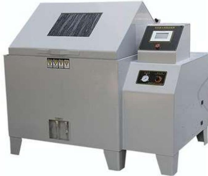
**Figura 9 – Máquina de ensayo de niebla salina.**
