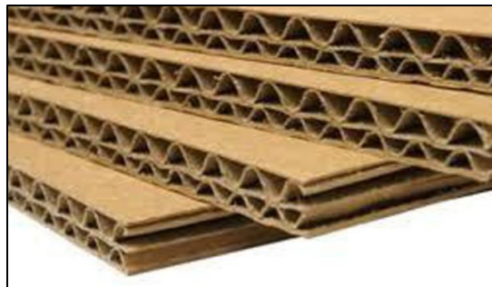
Figura 15. Textura interior de cajas de cartón
