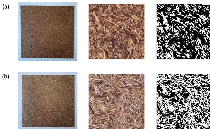
Figura 7.4. Apariencia visual, aumento a 10X y ajuste de color blanco-negro del material compuesto de (a) matriz acrílica y (b) matriz vinil-acrílica.
