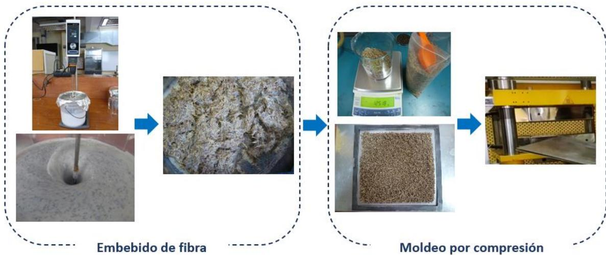
Figura 7.2. Elaboración de materiales compuestos de matriz acrílica y vinil-acrílica
