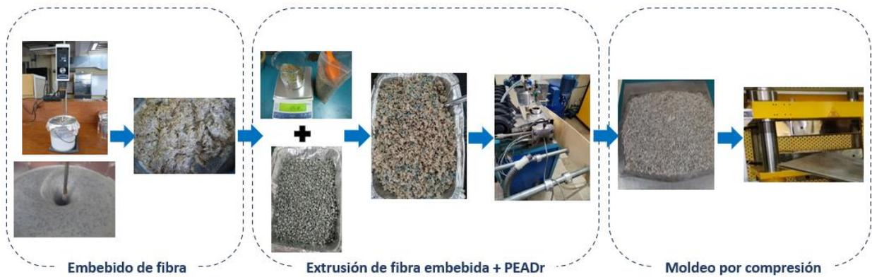
Figura 7.17. Elaboración de materiales compuestos de matriz híbrida: acrílica-PEADr
