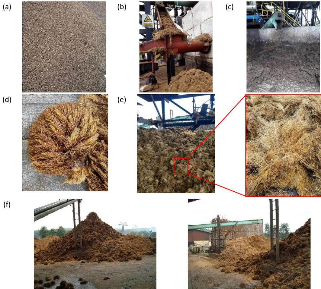
Figura 1.4 Residuos generados en la extracción de aceite crudo de palma y palmiste: (a) Cuesco, (b) Fibra mesocárpica, (c) Lodo, (d) Raquis previo a compresión, (e) Raquis posterior a compresión y (f) Acumulación de residuos
