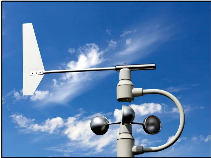
**Figura 1-6 Dispositivo de medición de vientos**
