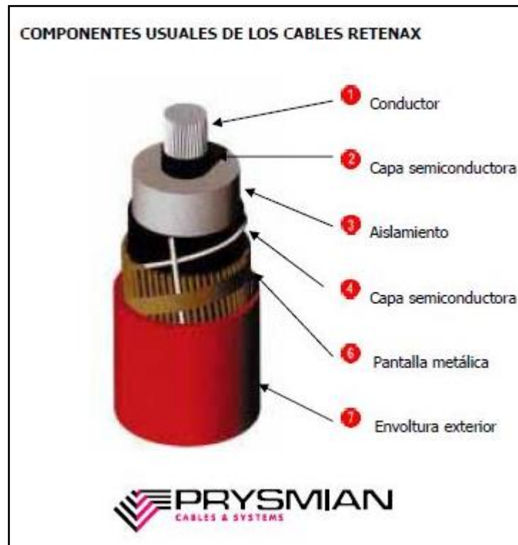
Figura ID-62: Prysmian, 2009, Partes del conductor - cables para redes de MT, imagen, catálogo general Prysmian.
