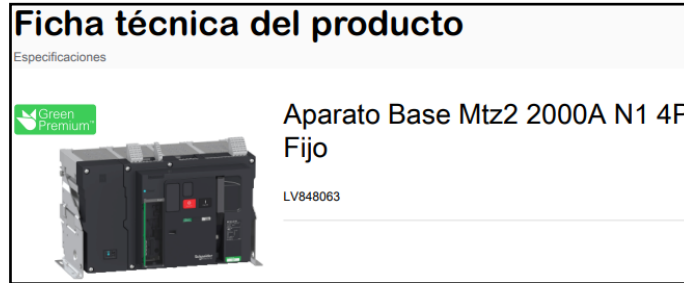
Figura ID-39: Schneider Eléctric, 2023, Interruptor automático principal 1 y 2, imagen, https://www.se.com/ar/es/product/LV848063/aparato-base-mtz2-2000a-n1-4p-fijo/ .
