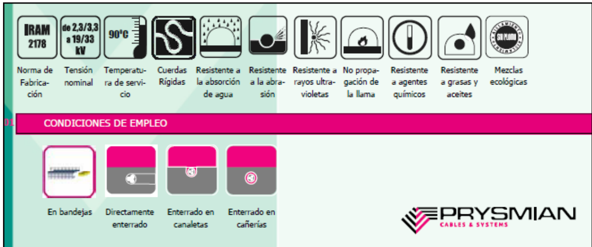
Figura ID-61: Prysmian, 2009, Características de alimentadores en MT - cables para redes de media tensión, imagen, catálogo general Prysmian.
