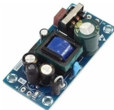
Figura 32: Fuente tensión Auxiliar 220 VCA / 5
