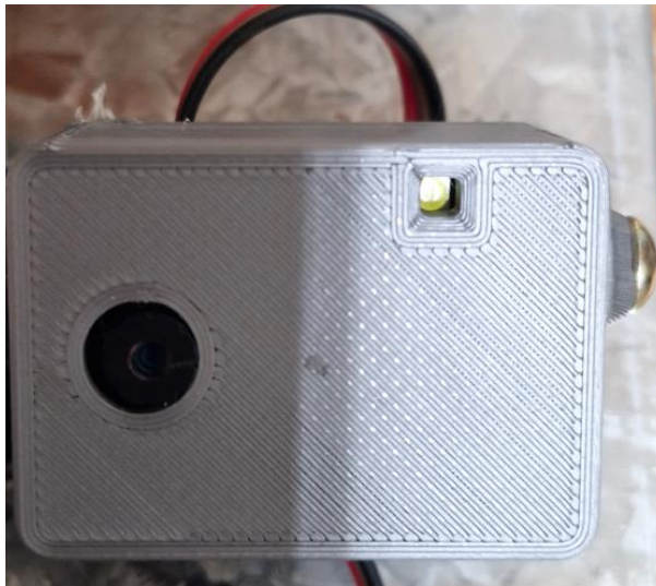
Figura 44: Bloque 6- Sensor de Temperatura de movimiento ESP32 -CAM
