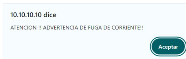
Figura 63: Alarma Posible Peligro por Tensión de Paso
