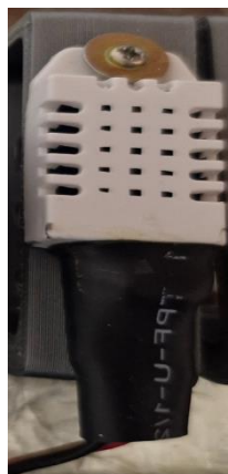
Figura 43: Bloque 5- Sensor de Temperatura DHT22
