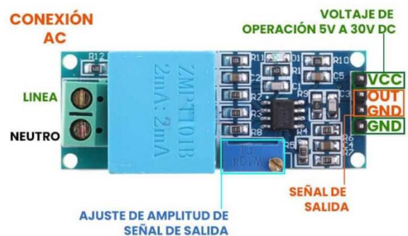
Figura 25: Diagrama Conexiones Sensor ZMPT101B
