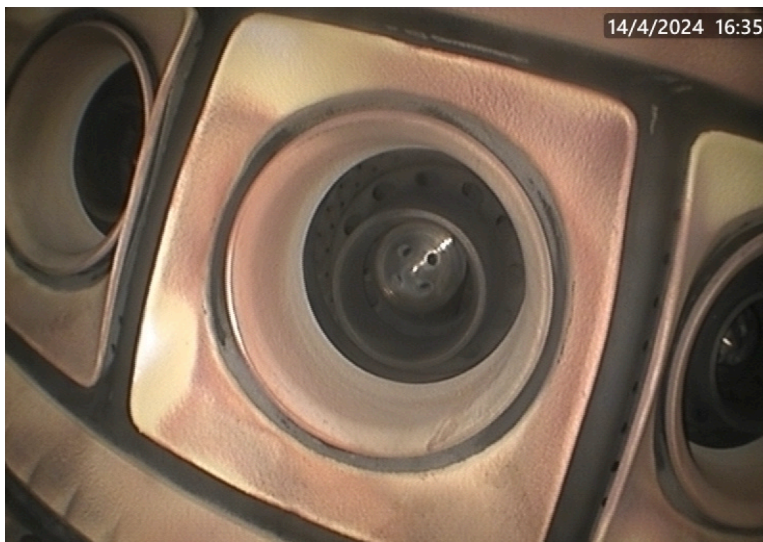
Fig. 36 – boquillas de inyección a la cámara de combustión de una turbina de gas real.
