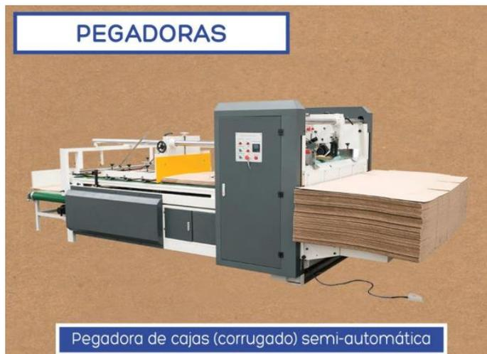
Ilustración 22 - Plegadora y adhesivadora
