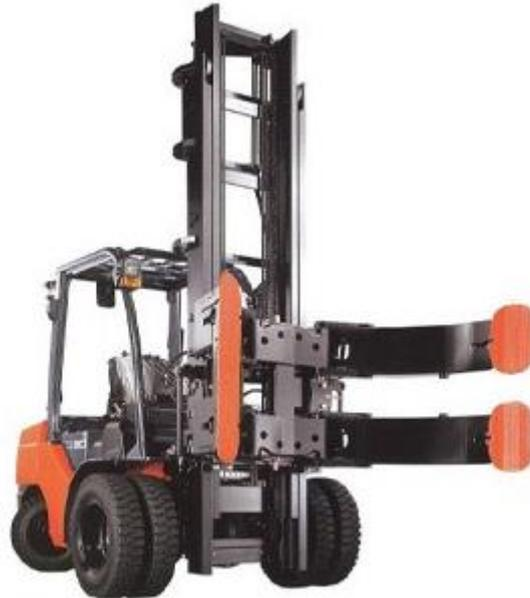
*Ilustración 26- Autoelevador apilador con pinza para bobinas*
