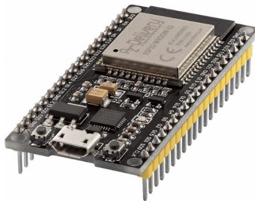
Figura 2: Microcontrolador ESP32. Imagen extraída de [5]
