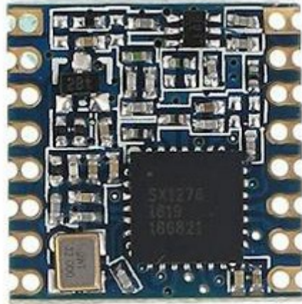
Figura 5: Dispositivo LoRa SX1276. Imagen extraída de [7]
