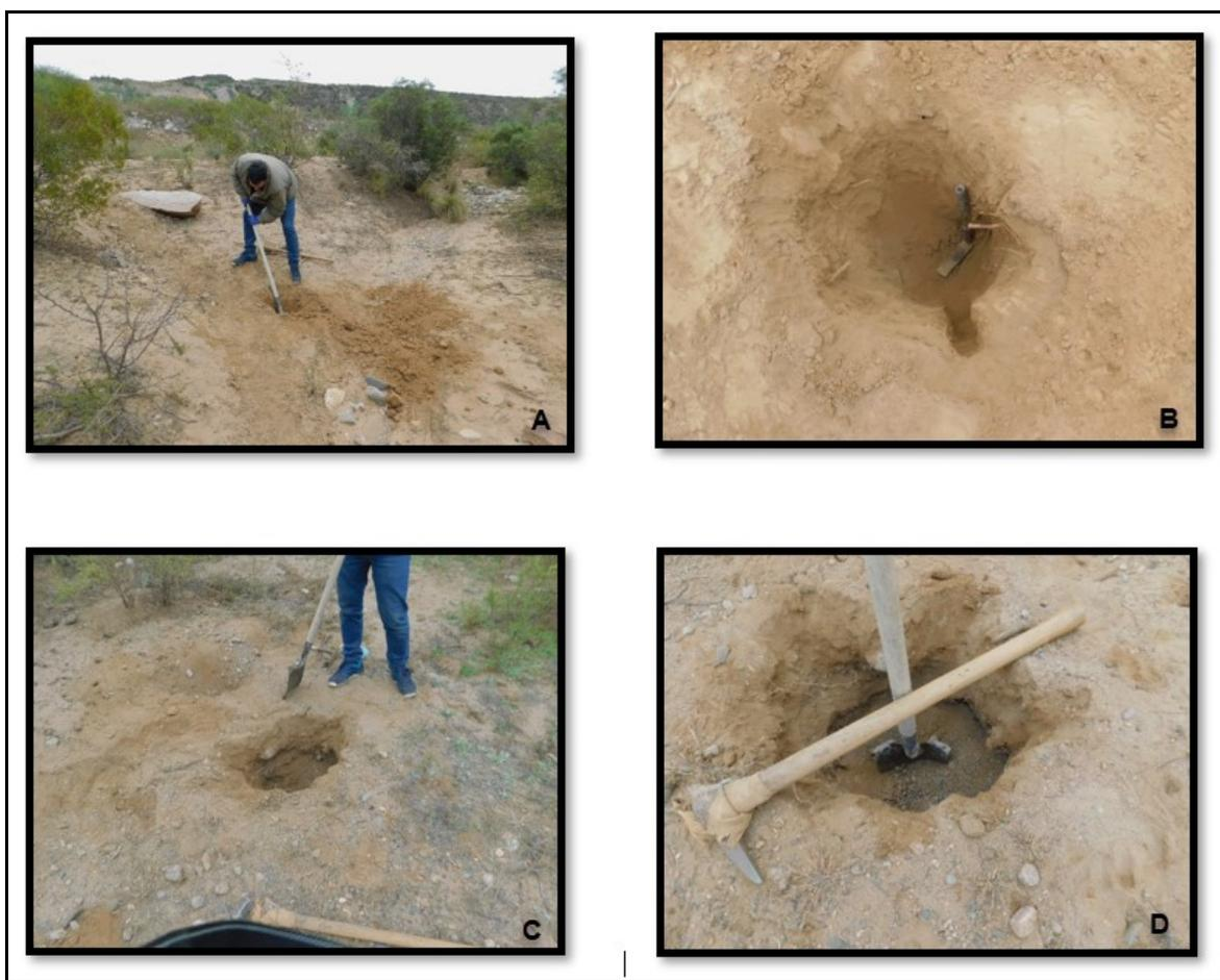
Vista de muestreo de suelos: (A) Visual de destape en P1 y preparación de perfil; (B) Vista en planta de perfil P1; (C), Visual de destape en P2 y preparación de perfil; (D) Vista en planta de pozo de perfil P2.
