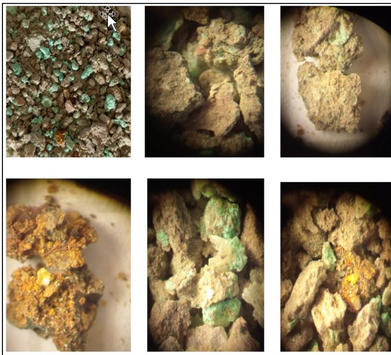
Muestras con signo de oxidación ( $\text{FeOx}$ ) y sulfatos de cobre. Se observa una homogenización de la alteración, siendo pervasiva a toda la muestra.
