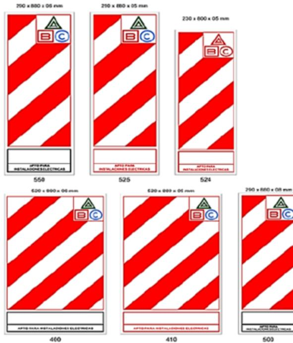
Figura 5.10. Chapas baliza para extintores de fuego.
