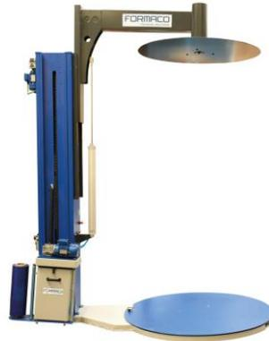
Figura 10.27. Estrichadora Formaco automática.
