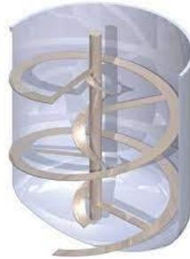
Figura 3.7. Reactor con agitador helicoidal.
