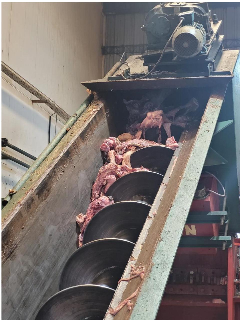
*Figura 20: Sinfin alimentación triturador*
