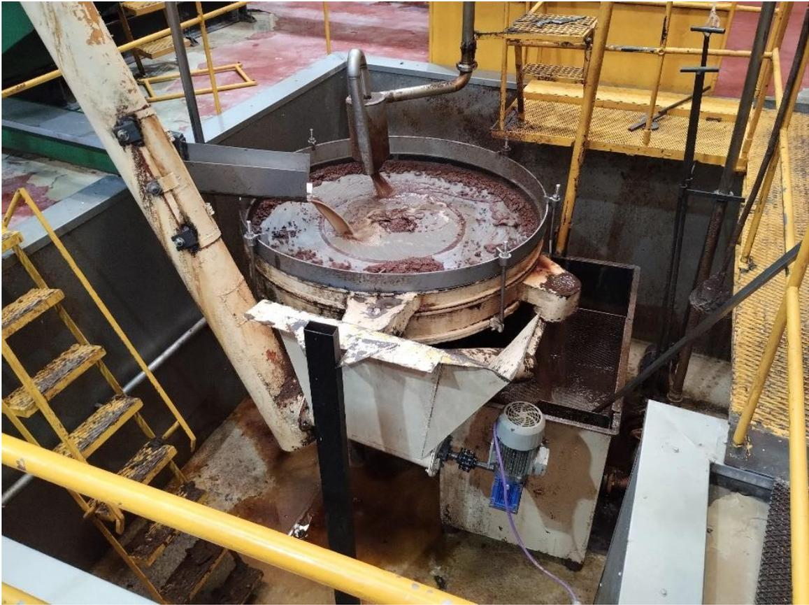
*Figura 14: Zaranda vibradora*
