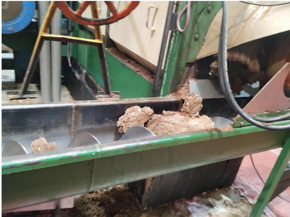
Figura 21: Sinfin salida de prensas expeller
