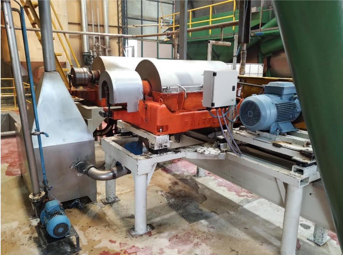
*Figura 15: Centrifugadora D-Canter.*
