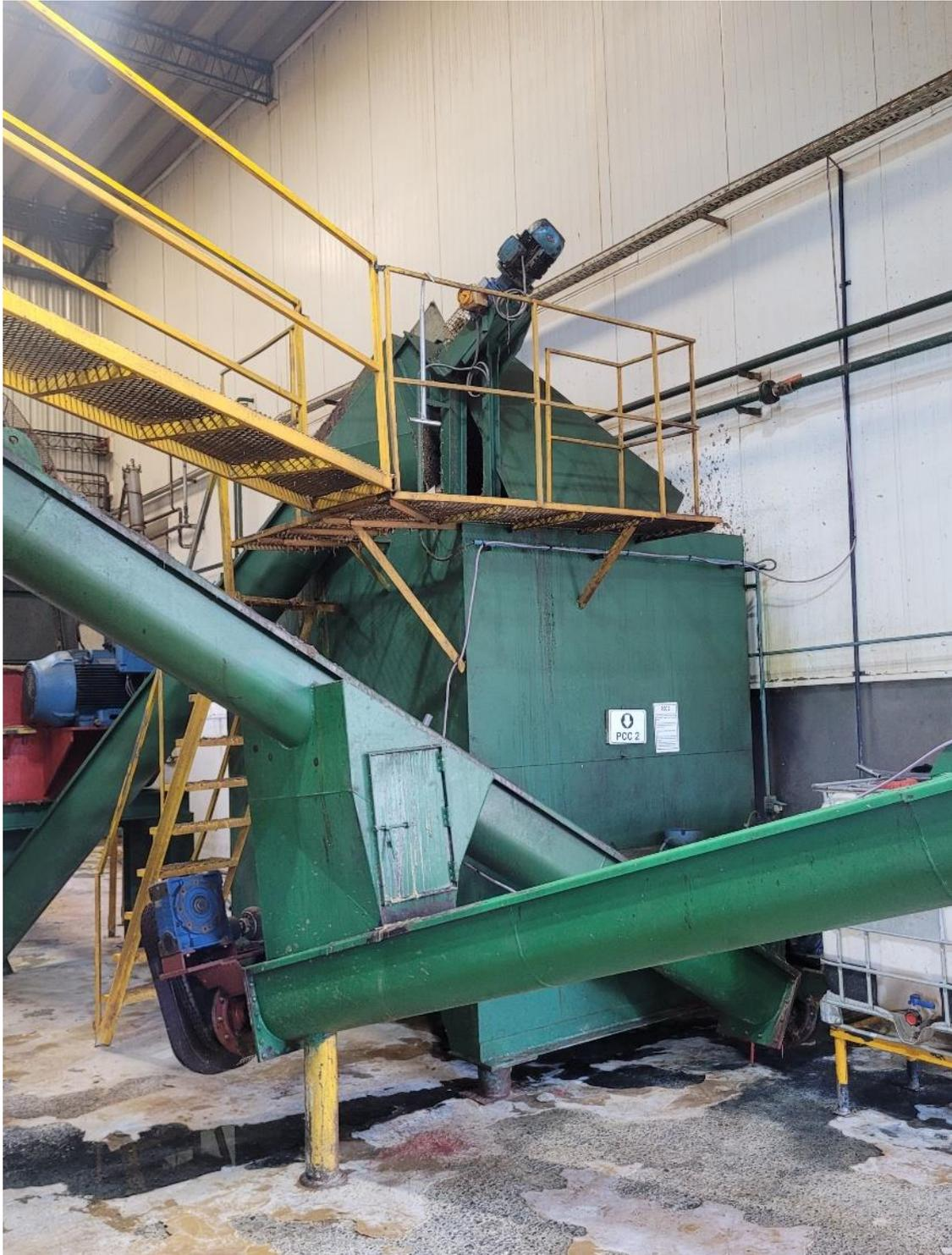
*Figura 17: Tolva alimentación digestor*
