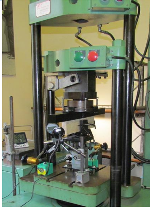
Figura 3 : Dispositivo de carga, dirección perpendicular a las fibras
