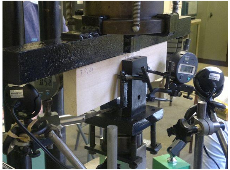
Figura 3 : Dispositivo de carga, dirección perpendicular a las fibras
