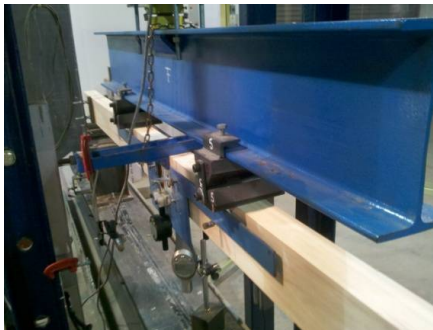
Figura 4: Ensayo de una viga
