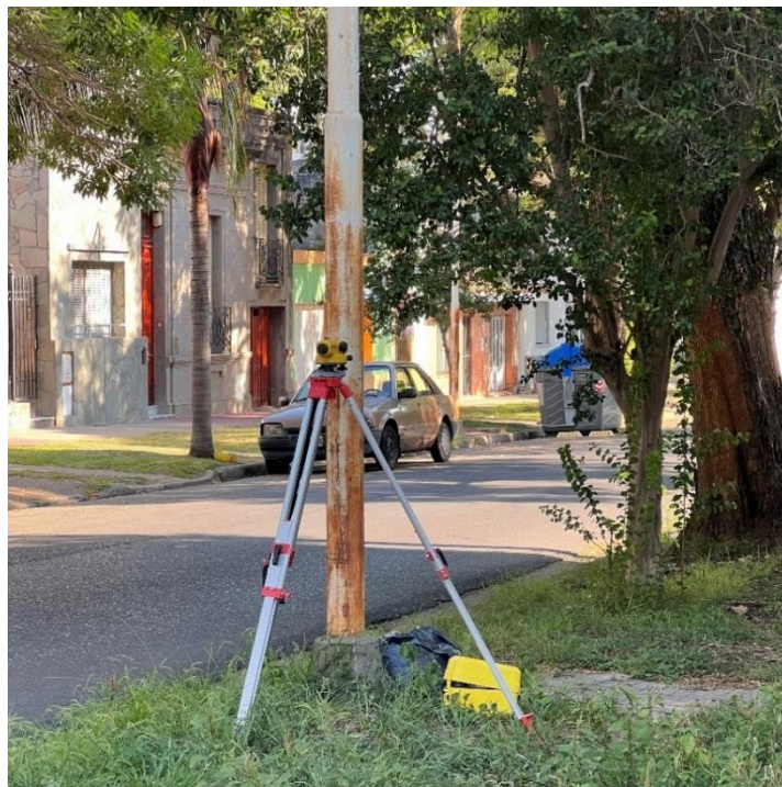
Figura N° 4 – Nivel óptico posicionado junto a poste de luz
