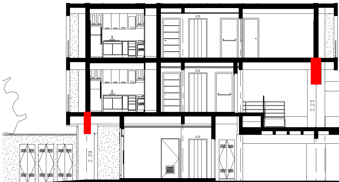
Figura N° 26 – vigas de apeo
