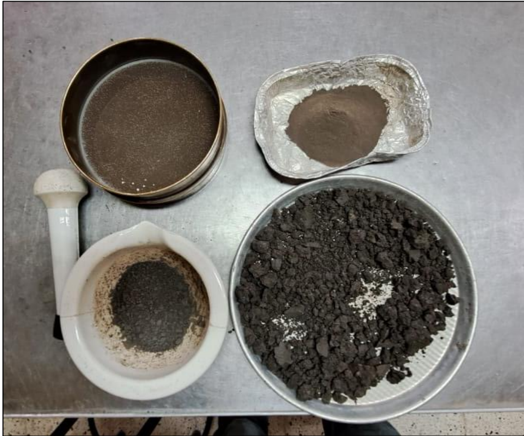
Figura 6.6 – Muestra de suelo molida y pasada por tamiz N°40 para límites de Atterberg
