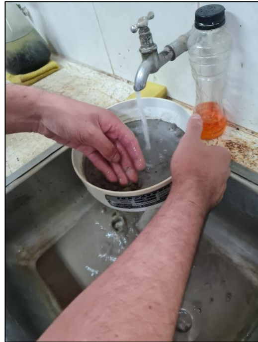
Figura 6.8 – Lavado de muestra en tamiz IRAM N°200
