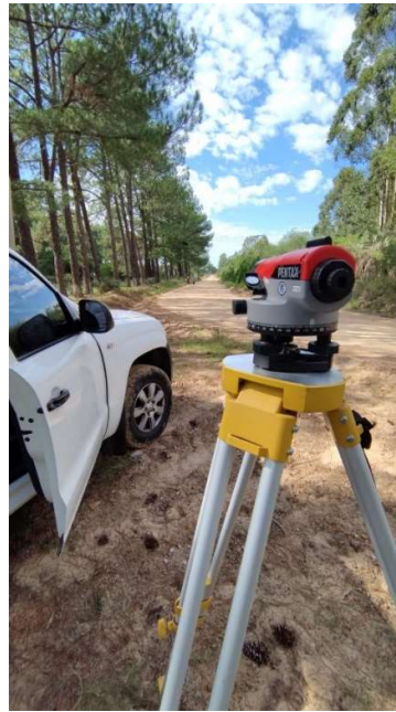
Imagen 3.1-2 Nivel óptico y planilla de anotaciones Imagen 3.1-3 Relevamiento del camino
