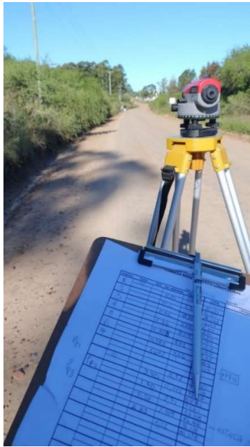
Imagen 3.1-2 Nivel óptico y planilla de anotaciones Imagen 3.1-3 Relevamiento del camino
