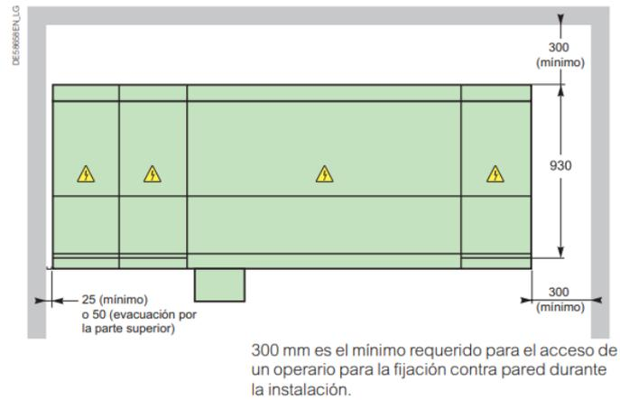
**Figura 15.** – Distancias recomendadas de celdas. extraído de catálogo «SM6 Solución modular
