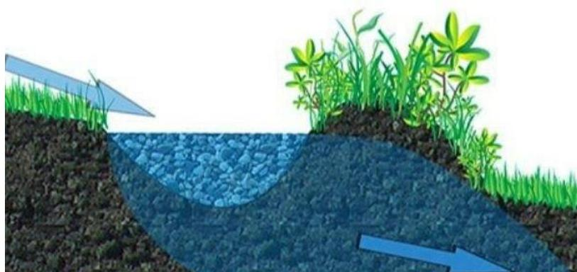
*Imagen 10: ejemplo de Zanja de Infiltración*
