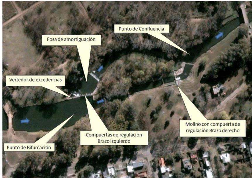
*Imagen 9: Vista general de la zona del Balneario, tramo de bifurcación del cauce del río Areco – Fuente: “Plan de Manejo Hídrico de la cuenca del Río Areco”*
