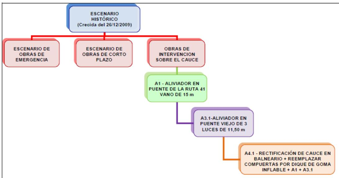
Imagen 33: "Esquema del conjunto de obras de intervención en el cauce seleccionadas" – Fuente: "Plan de Manejo Hídrico de la cuenca del Río Areco".
