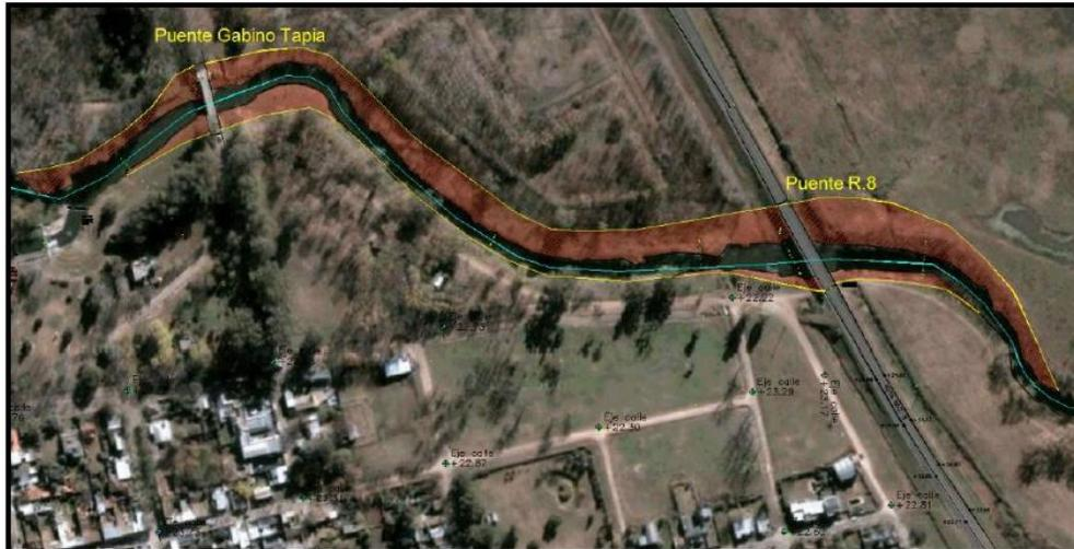
Imagen 22: Vista en planta de rectificación y ampliación de capacidad del cauce y en el puente
