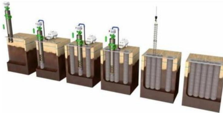
Imagen 17. Concepto de pantalla de pilotes secantes
