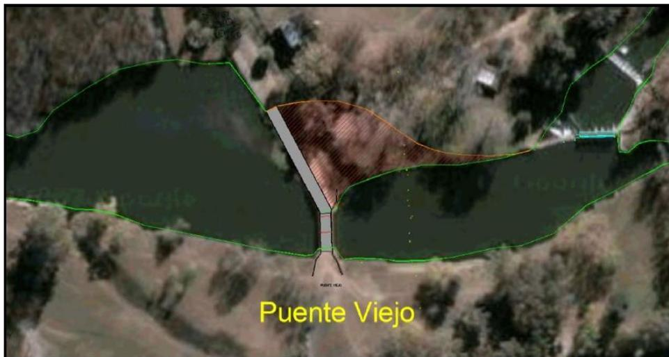
Imagen 26: “Vista en Planta de la ubicación del aliviador y el tramo de la rectificación del cauce en el Puente Viejo.” – Fuente: “Plan de Manejo Hídrico de la cuenca del Río Areco”
