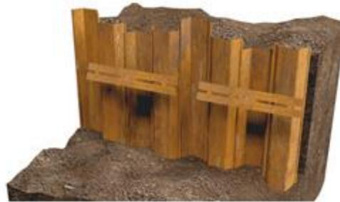
*Imagen 13. Concepto de muro de contención con tablestacas de madera*
