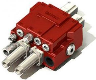
Válvula especial de dos correderas para cargadoras grandes con la posibilidad de instalar todas las conexiones de la bomba, el cilindro y el tanque en una dirección. Diseñado para sistemas de detección de carga de centro abierto.
