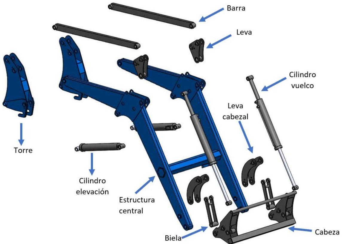
Ilustración 9 - Partes del Cargador
