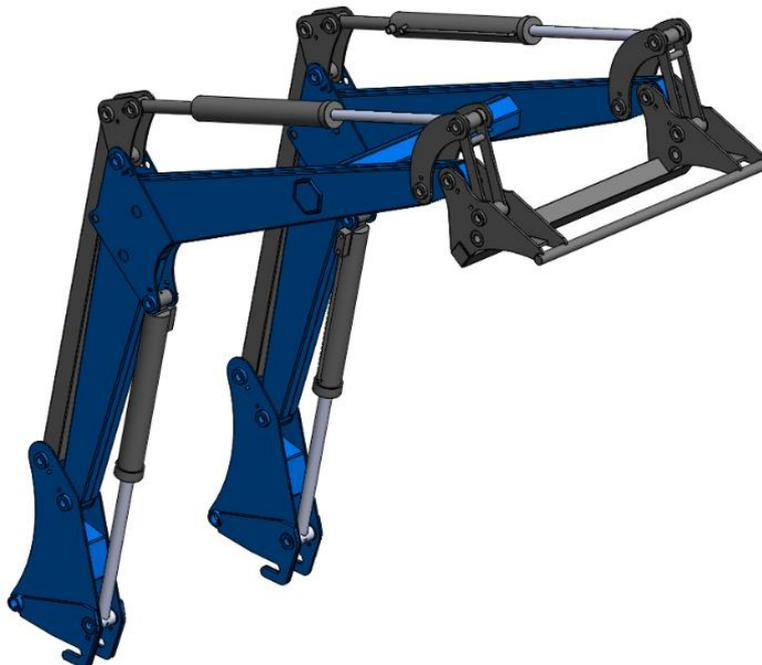
*Ilustración 77 - cargador en posición superior para descarga*
