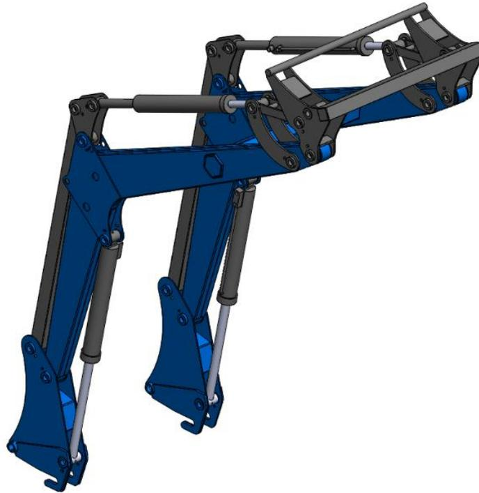
*Ilustración 76 - cargador en posición superior para traslado*
