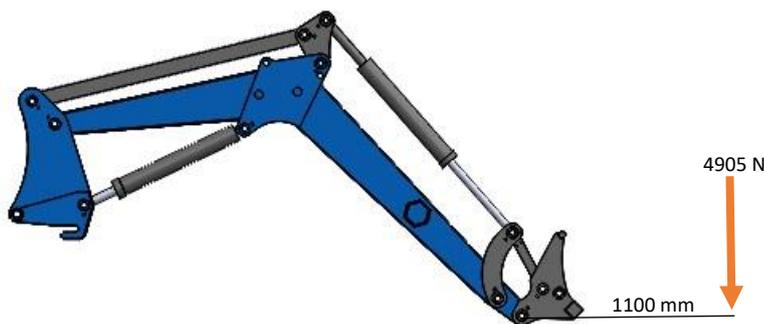
Ilustración 7 - Cargador en posición 1
