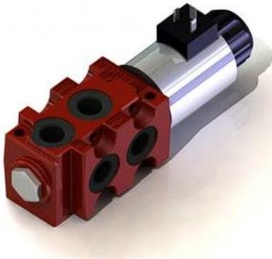
La válvula selectora de circuito SVB 04/06 6/2 está diseñada para redirigir el trabajo y el flujo de retorno de una función a otra y puede tener hasta 3 válvulas separadas apiladas juntas, lo que permite al usuario dirigir un flujo a hasta tres funciones diferentes activando la válvula con un solenoide de acción directa de 12 V o 24 V. El SVB también está disponible en versión neumática, hidráulica y manual.
