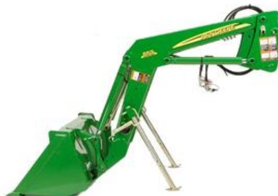
*Ilustración 1 - Cargador sin autonivelación*
