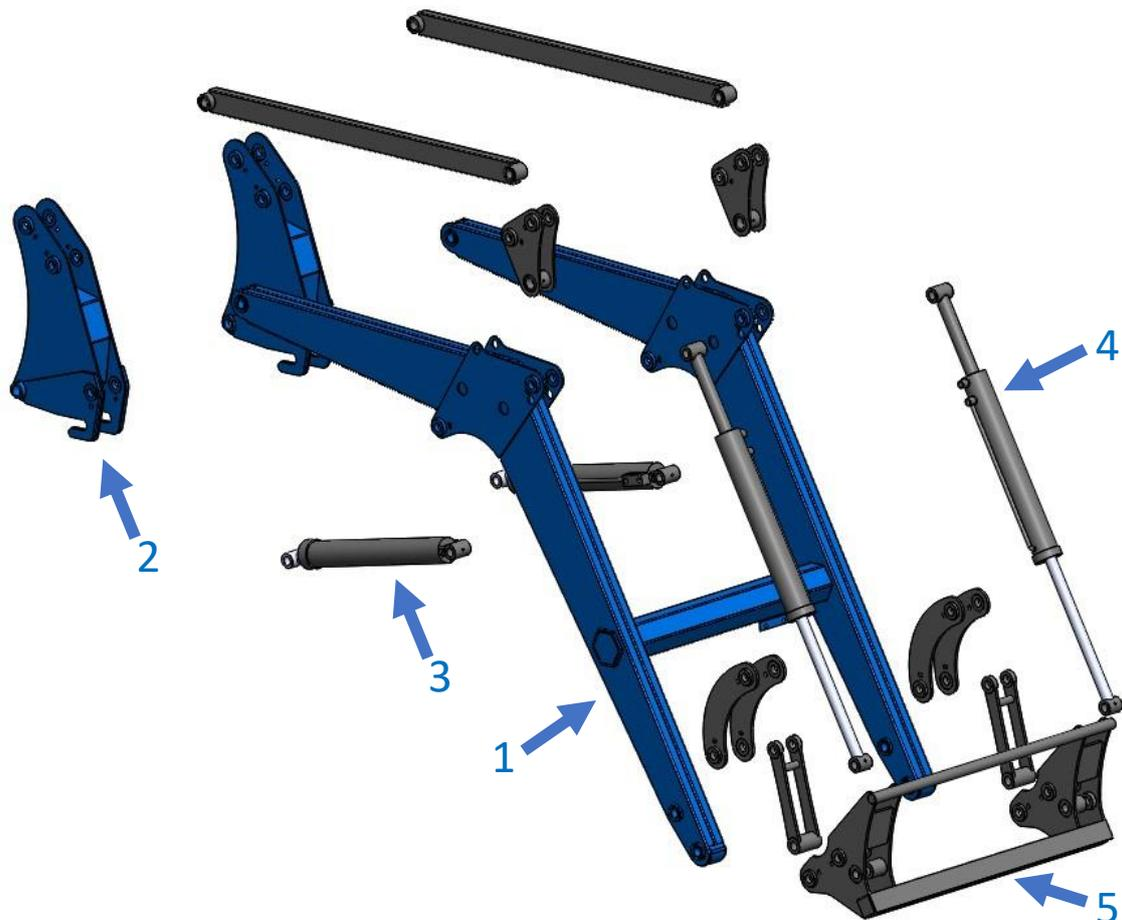
*Ilustración 5 - Despiece general del cargador*
