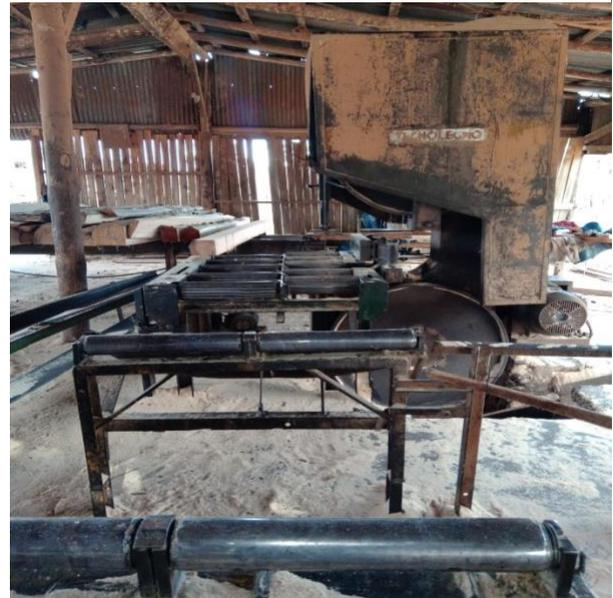
**Sierra Sin Fin:** Está compuesta por dos volantes, dispuesto en un mismo plano de forma vertical u horizontal, que se encuentra unido por medio de una cinta de acero dentada, que es la herramienta de corte, un motor eléctrico acciona uno de los volantes, a través de un sistema de correas, generando el movimiento de la sierra.
