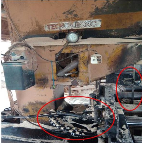
Ilustración 8 Máquina tableadora con sistema de rodillos
