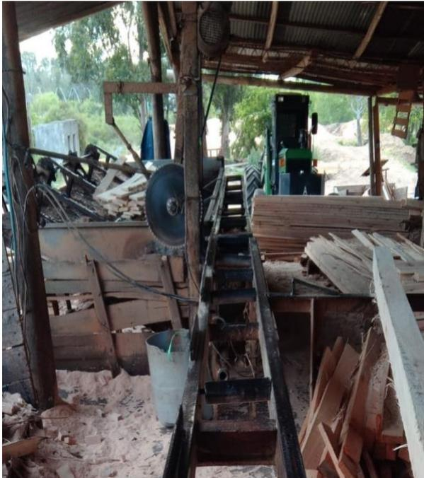
*Ilustración 6 Máquina Despuntadora*
