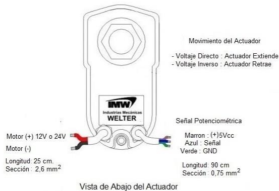
fig. n° 23: Esquema de conexión del actuador.
