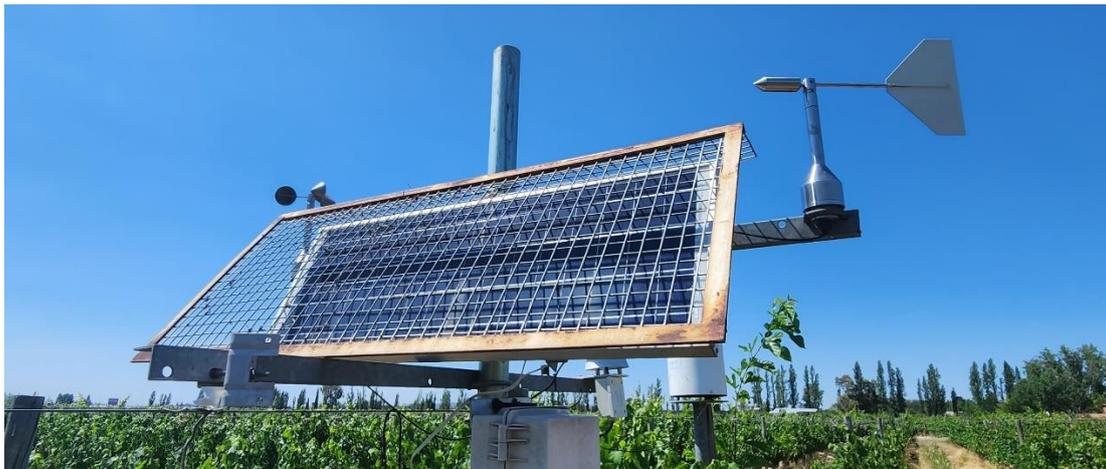
El panel solar tiene una eficiencia de conversión de más del 14%, asegurando una captura eficaz de la energía solar incidente. Con una corriente de carga de aproximadamente 0.59 A, el tiempo estimado para cargar completamente la batería MG1270 es de alrededor de 12 horas bajo condiciones ideales.
