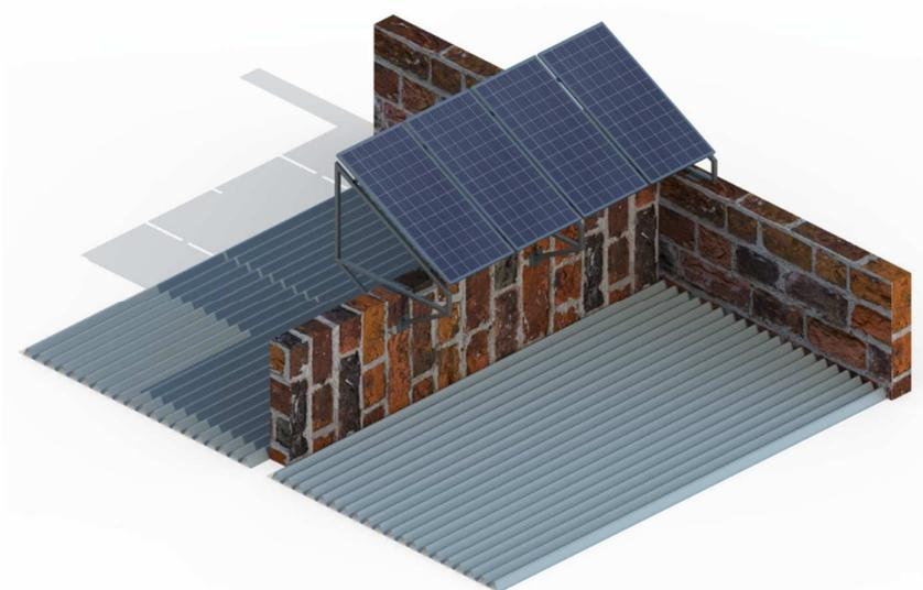
Figura 3.29. Montaje de la estructura de los paneles solares
