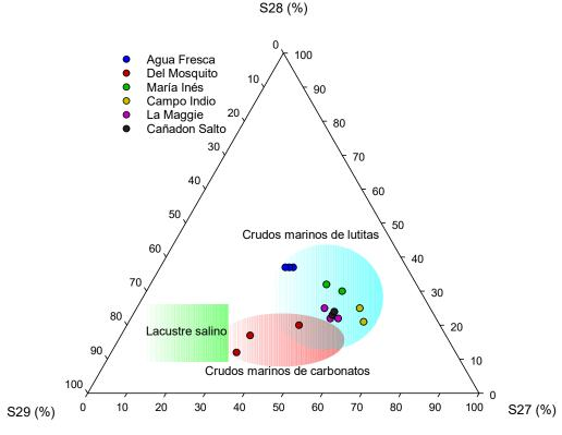
**Figura 19.** Diagrama ternario de esteranos para los crudos analizados. Modificado de Moldowan *et al.* 1985.
