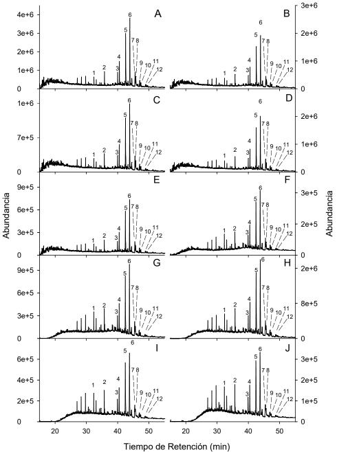
**Figura 23.** Fragmentogramas (m/z = 191) del crudo AS extraído de agua de mar a los tiempos T0 (A) a T9 (J). 1: terpano tricíclico  $C_{23}$  ( $T_{23}$ ), 2: terpano tricíclico  $C_{26}$  ( $T_{26}$ ), 3: trisnorneohopano (Ts), 4: trisnorhopano (Tm), 5: norhopano  $C_{29}$  ( $H_{29}$ ), 6: hopano  $C_{30}$  ( $H_{30}$ ), 7-8: homohopanos  $C_{31}$  (R y S), 9-10: homohopanos  $C_{32}$  (R y S), 11-12: homohopanos  $C_{33}$  (R y S).
