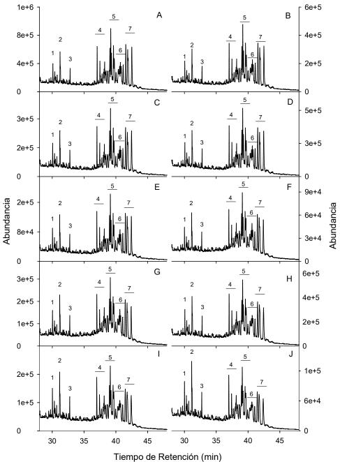
**Figura 24.** Fragmentogramas (m/z = 217) del crudo AS extraído de agua de mar a los tiempos T0 (A) a T9 (J). 1: esterano  $C_{20}$  ( $S_{20}$ ), 2: esterano  $C_{21}$  ( $S_{21}$ ), 3: esterano  $C_{22}$  ( $S_{22}$ ), 4: diasteranos  $C_{27}$  ( $D_{27}$ ). 5: colestanos ( $S_{27}$ ), 6: ergostanos ( $S_{28}$ ), 7: estigmastanos ( $S_{29}$ ).
