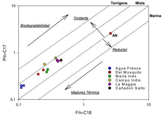
**Figura 16.** P/n-C<sub>17</sub> en función de F/n-C<sub>18</sub> para los crudos estudiados (Shanmugam 1985).
