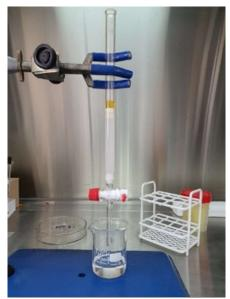
**Figura 7.** Cromatografía en columna de una de las muestras de crudo.
