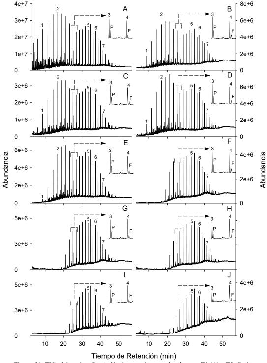
**Figura 21.** TICs del crudo AS extraído de agua de mar a los tiempos T0 (A) a T9 (J). 1: decano (n-C10), 2: tridecano (n-C13), 3: heptadecano (n-C17), 4: octadecano (n-C18), 5: docosano (n-C22), 6: pentacosano (n-C25), 7: octacosano (n-C28), P: pristano, F: fitano.
