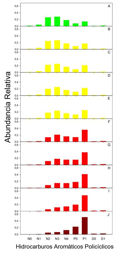
**Figura 26.** Histogramas de HAPs para los crudos extraídos de suelo a los tiempos T0 (A) a T9 (J).  $N_X$ : naftaleno y metilderivados,  $P_X$ : fenantreno y metilderivados,  $D_X$ : dibenzotiofeno y metilderivados.
