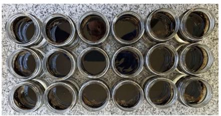
Figura 9. Sistemas de crudo y agua de mar en los frascos de vidrio.
