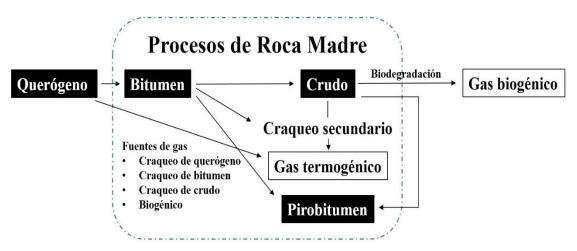
Figura 1. Procesos que tienen lugar en una roca generadora. Adaptado de Jarvie et al. 2007.
