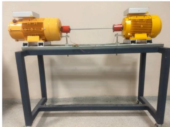
Fig. 1 - Vista del generador, eje de torsión, motor y los sensores en cada manchón
