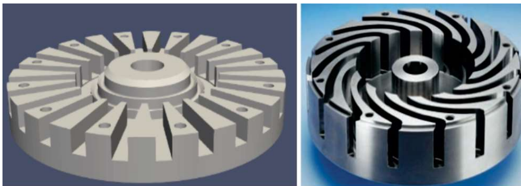
Figura 4.2. Variantes geométricas de discos rotativos
