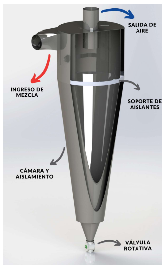
Figura 5.9. Diseño final del separador ciclónico.
