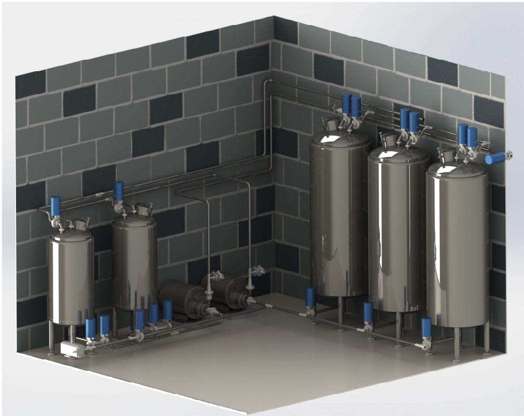
Figura 5.14. Tanques de alimentación y lavado CIP.
