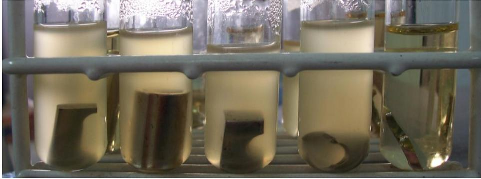
**Figura 3.** Ensayo de conducción bacteriana en prótesis. Los tubos 1 a 4 (positivos) contienen probetas con defectos metalmecánicos y el tubo 5 (negativo) una probeta sin defectos.
