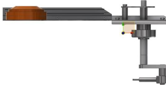
Ilustración 27. Lanzador y centro de masa
