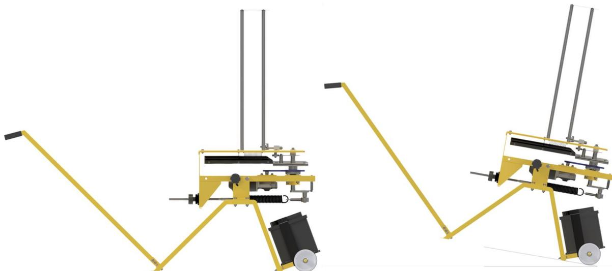
*Ilustración 59. Detalle de la base reposada y en movilidad*
