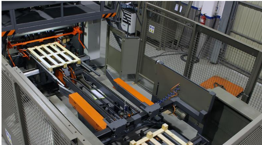
Clavadora Inferior automática con sistema hidráulico para clavar la parte inferior de los pallets de 2 y 4 entradas.
