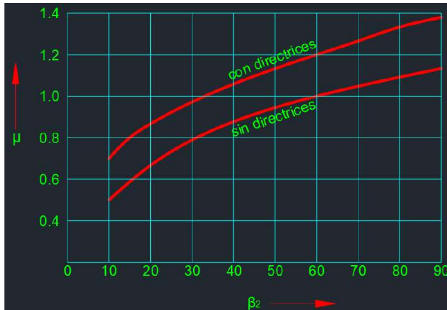
Figura 125 – El coeficiente \mu en función del ángulo \beta_2 para bombas radiales
