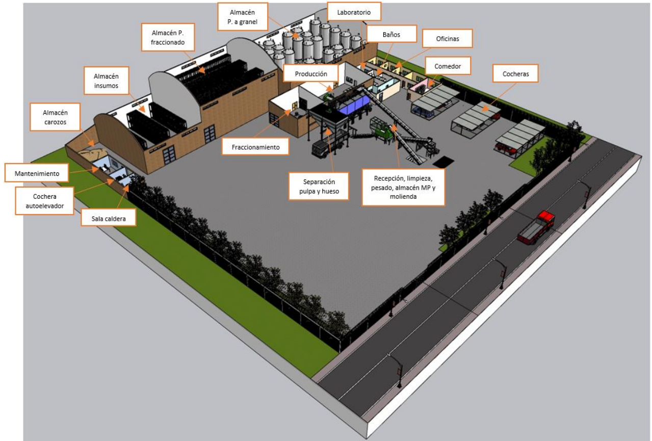
Ilustración 70. Disposición física de planta
