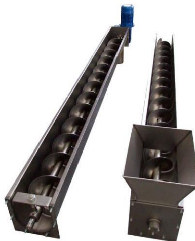
Ilustración 69. Tornillo sinfín transportador
