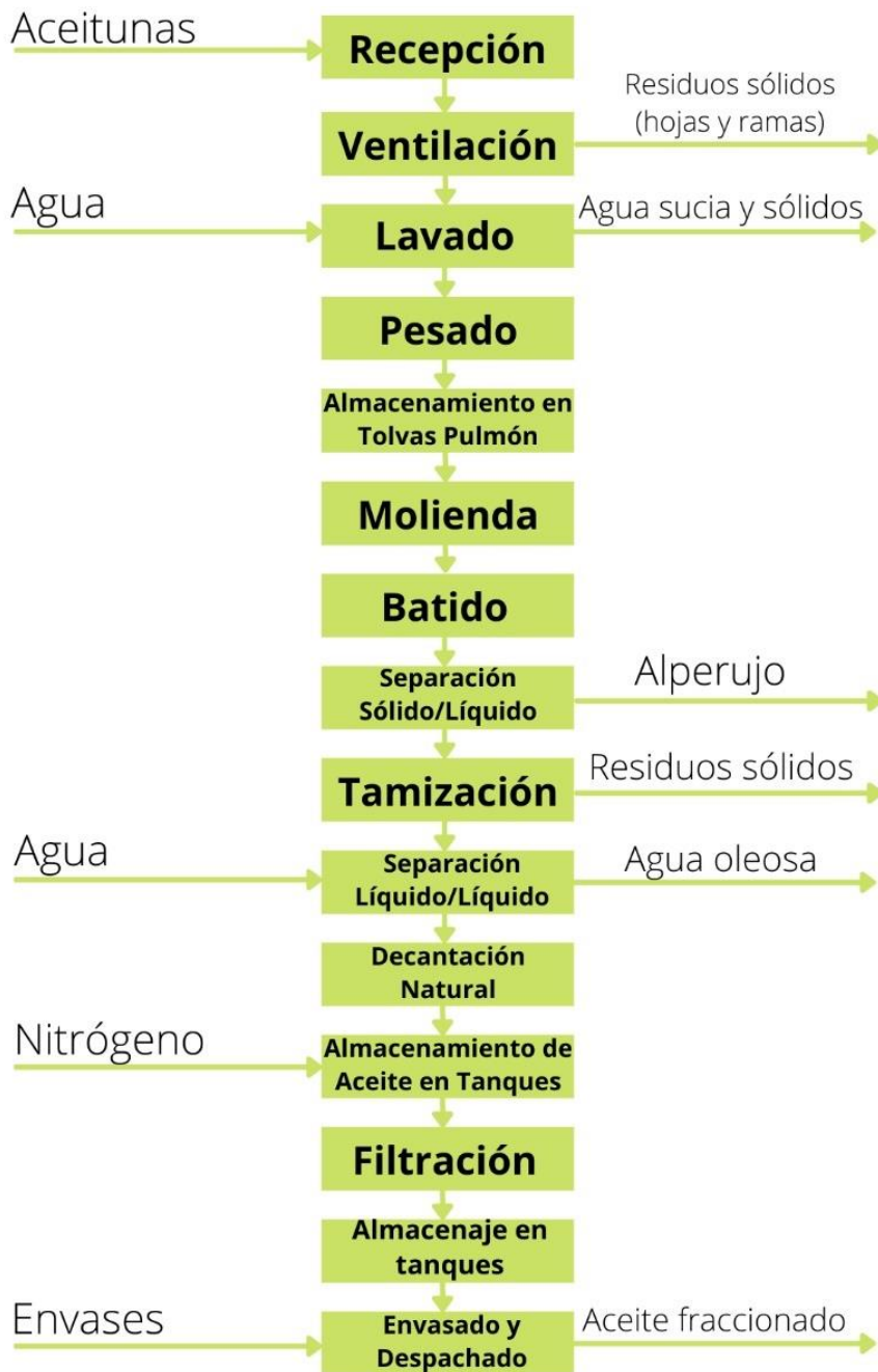
Ilustración 20. Diagrama de proceso de aceite de oliva
