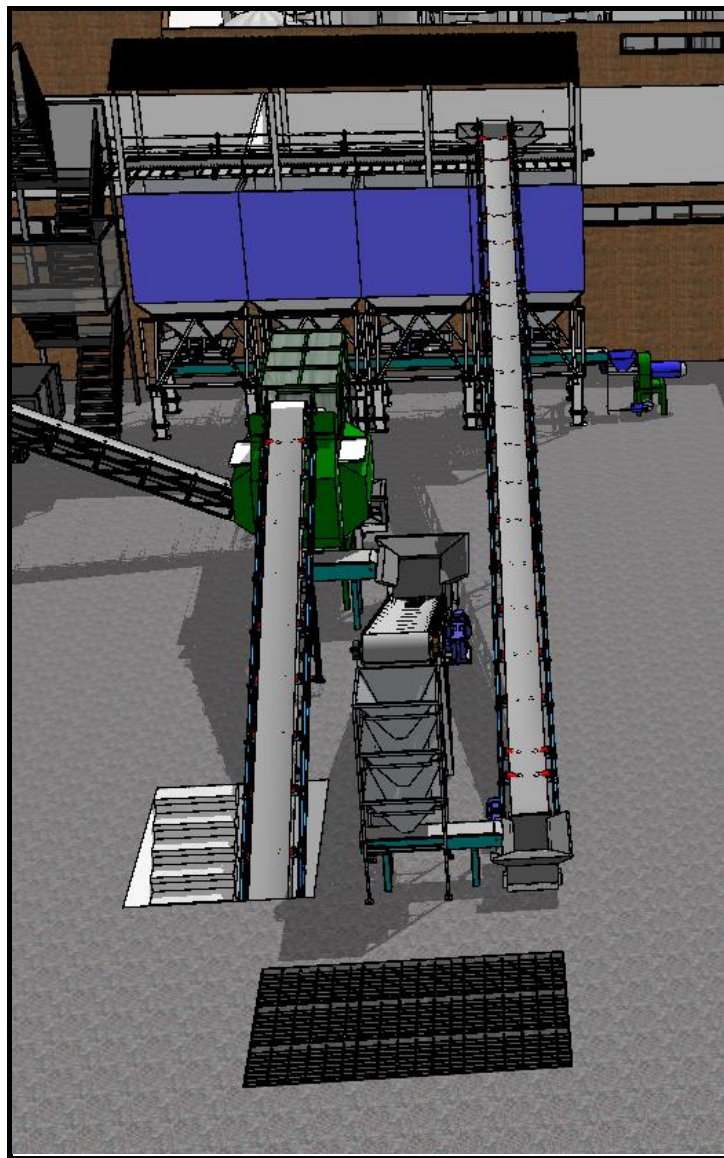
Ilustración 54. Patio de recepción, lavado, ventilado y pesado
