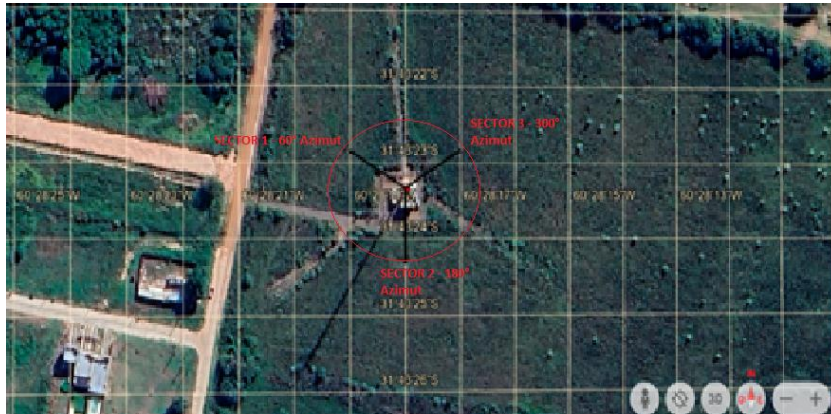
Figura N°. -18 Torre sitio Claro – Ángulos Azimut de cada sector.
