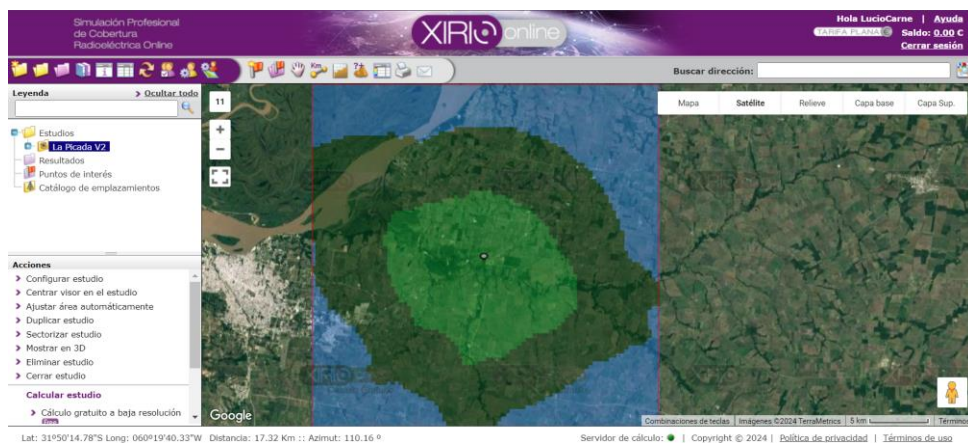
Figura N°. -13 Posición de la antena optimizada – Torre de 45m y 10W de potencia.
