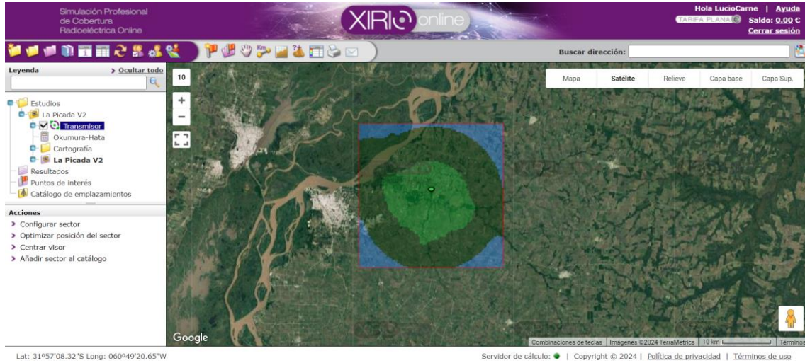
Figura N°. -10 Cobertura de la señal radioeléctrica – Torre de 45M y 20W de potencia.
