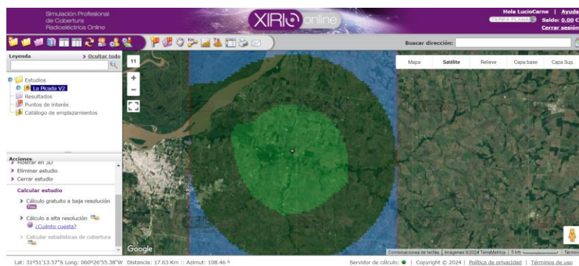
Figura N°. -14 Posición de la antena optimizada – Torre de 30m y 20W de potencia.
